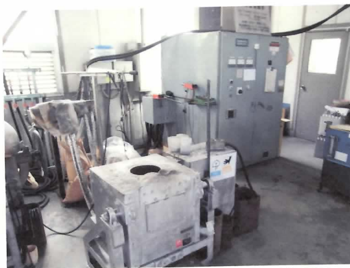
図 1 鋳鉄溶解に使用した高周波るつぼ型誘導炉
